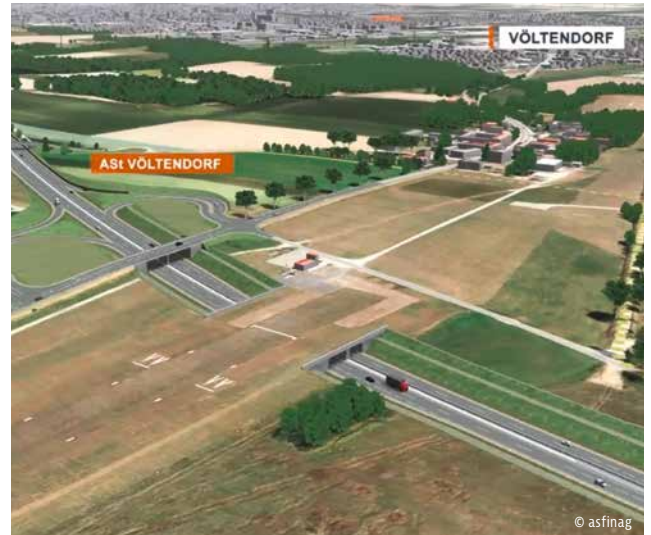
Bei Völtendorf verläuft die S 34 lärm-minimiert in Tieflage und wird unter dem Flugfeld durchgeführt.
